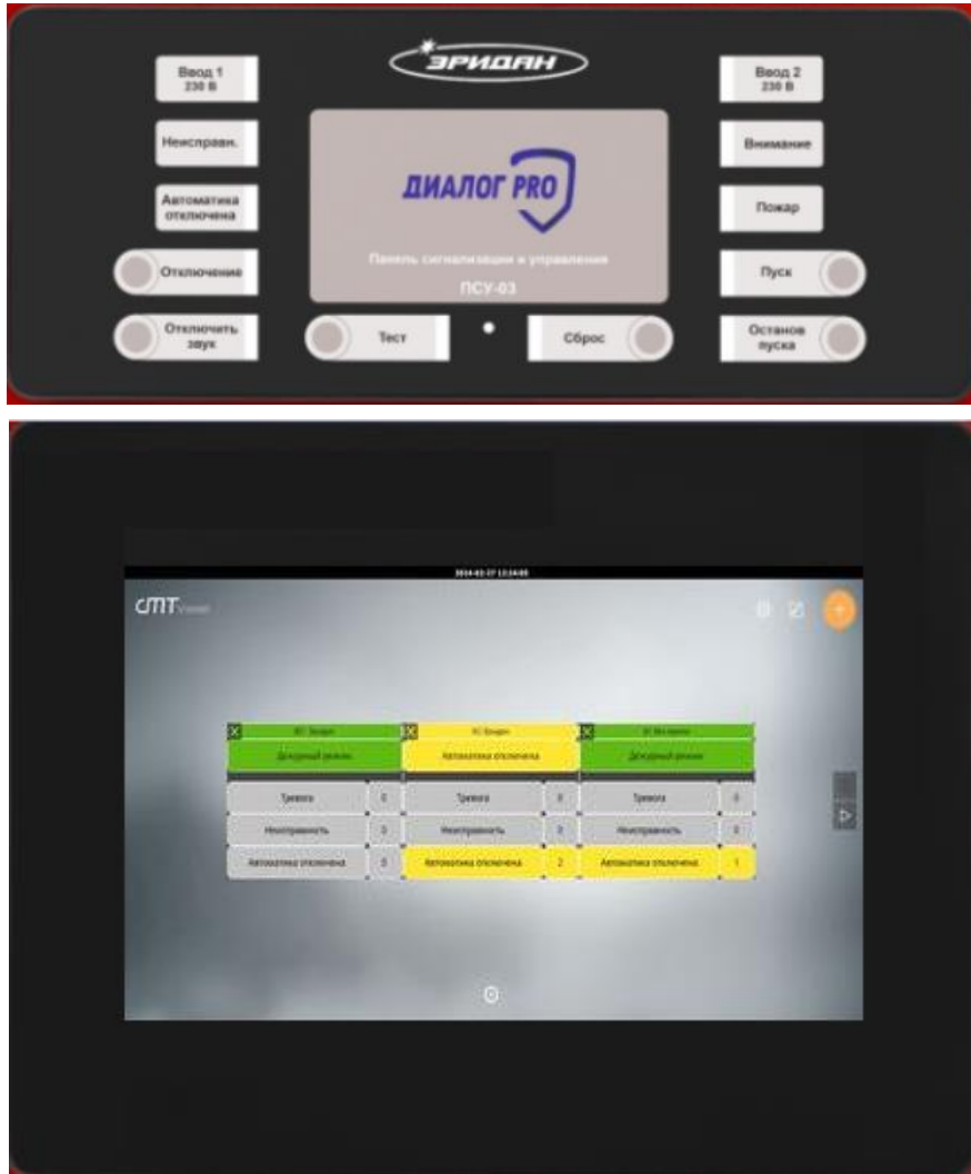
Рисунок 1.1 – Внешний вид панели оператора
