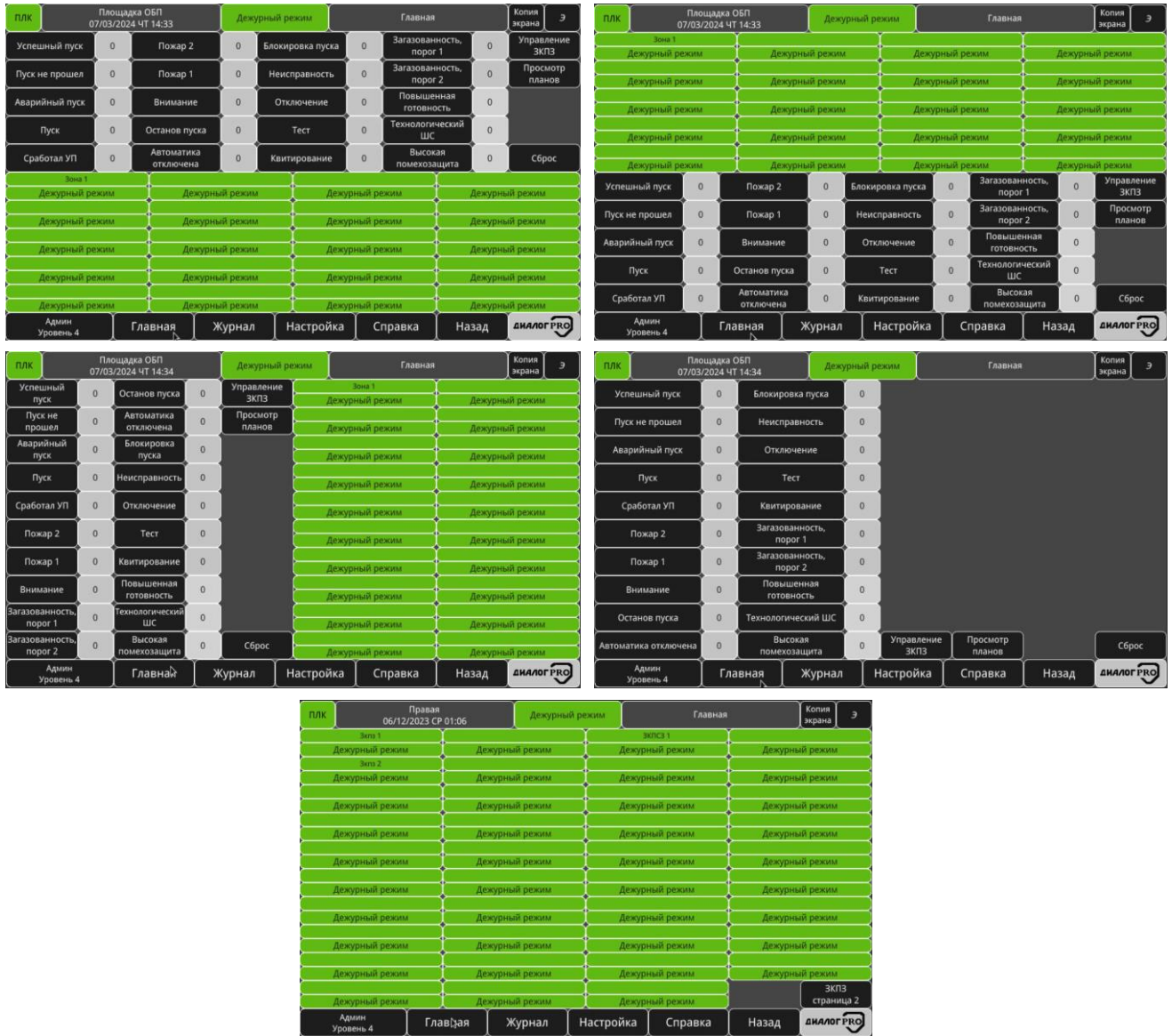
Рисунок 3.8 – Варианты окна «Главная», по порядку: «Счетчики событий + ЗКПЗ, вариант 1», «Счетчики событий + ЗКПЗ, вариант 2», «Счетчики событий + ЗКПЗ, вариант 3», «Счетчики событий», «ЗКПЗ»
