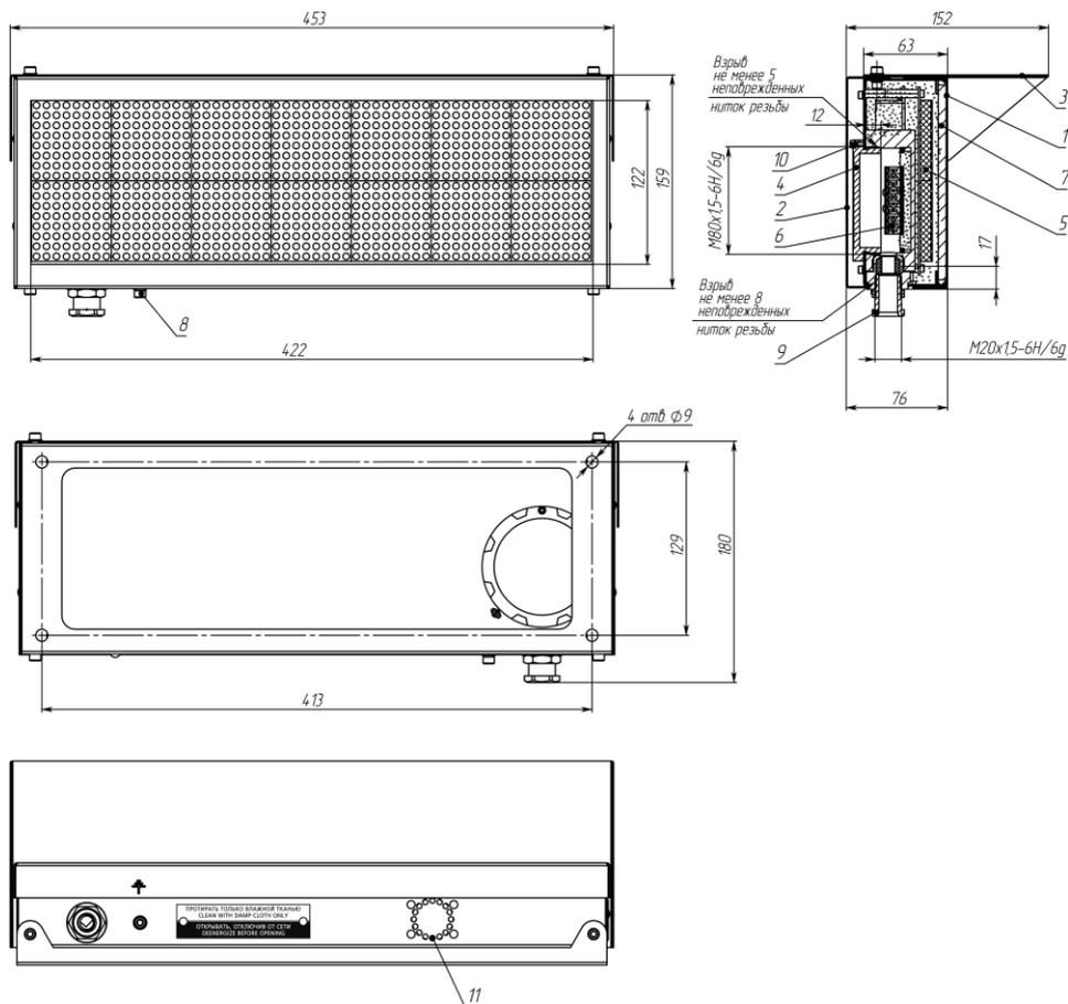
1 - корпус; 2 - кронштейн; 3 - козырек; 4 - клеммная коробка; 5 - плата индикации; 6 - плата клемм; 7 - стекло; 8 - винт заземления; 9 - кабельный ввод (показан для примера, расположение кабельного ввода – по согласованию с заказчиком); 10 - стопорный винт; 11 - пьезосирена.
