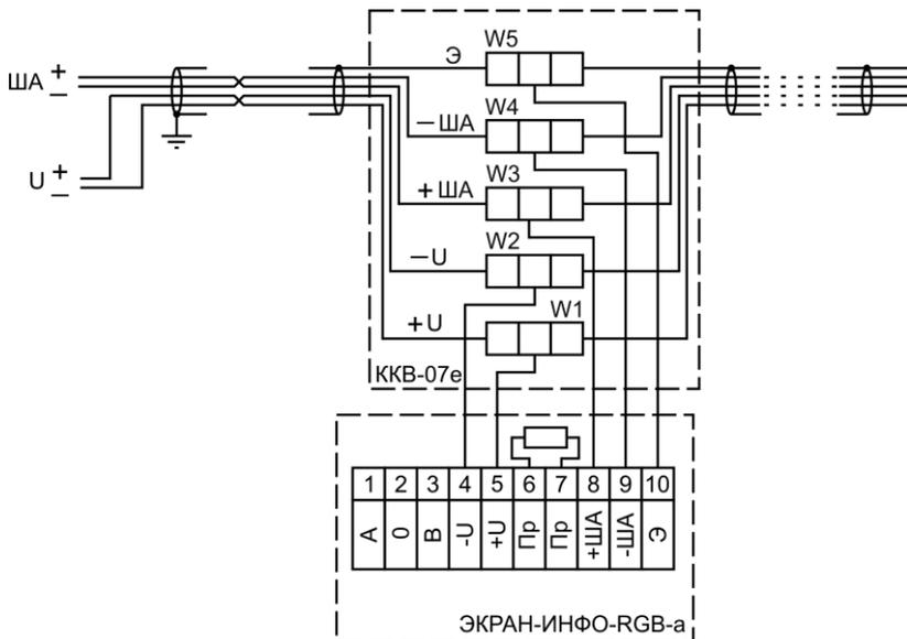
**U** - внешний развязанный источник питания  $U_n=24\text{ В} \pm 10\%$ ; **ША** - адресный шлейф прибора с поддержкой протокола «Дозор-07а»; **Э** - экран; **ККВ-07е** - внешняя коммутационная коробка; **W1-5** - соединительные клеммы WAGO 222-413 с нажимным рычагом или другие.
