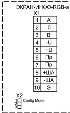
**A, B, 0** – клеммы интерфейса RS485 протокол Modbus RTU (для конфигурирования);
