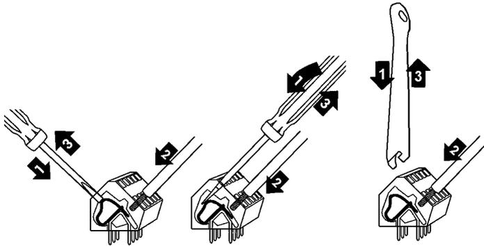
Для подключения проводников в клеммы:
