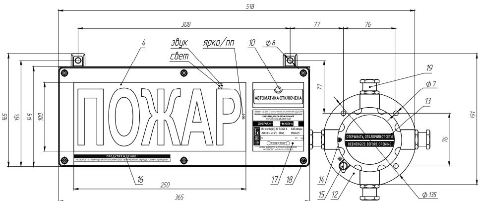
в) Внешний вид оповещателя ЭКРАН-ККБ с постоянно присоединенной внешней взрывозащищенной клеммной коробкой
