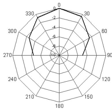
**Рисунок 5.** Диаграмма направленности звука ЭКРАН со звуковой функцией.
