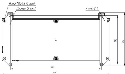
б) Монтаж планок АК-4Э (вид сзади)
