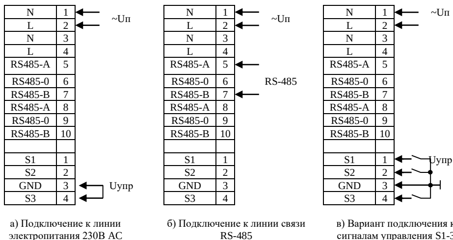
Рисунок Б.2 – Схемы подключения оповещателей BC-07е-3М(/СД)-230VAC
