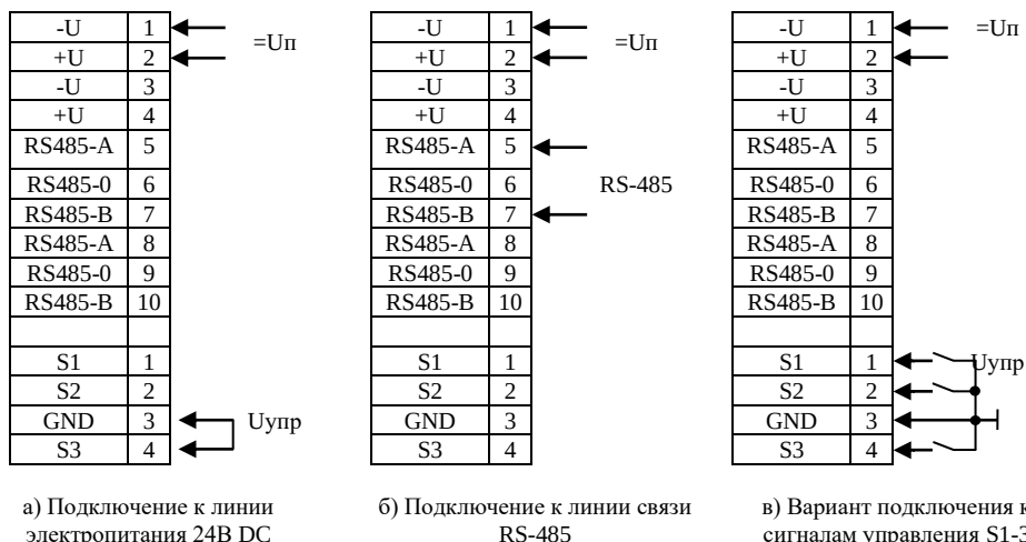
Рисунок Б.1 – Схемы подключения оповещателей BC-07е-3М(/СД)-24VDC
