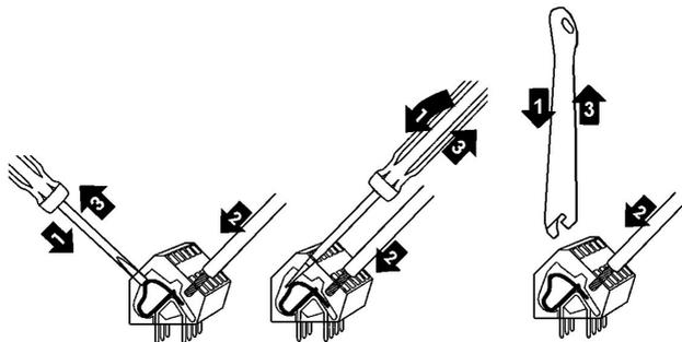
Для подключения проводников в клеммы:
