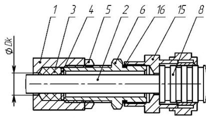
**г) монтаж кабелем в металлорукав КВМ**
