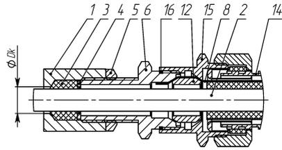
**и) монтаж бронированным кабелем в металлорукав в кабельном вводе КВВМ**
