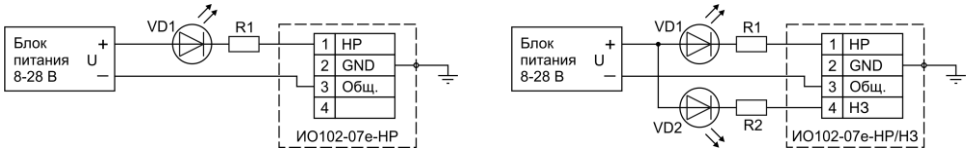
Рисунок 6. Расположение клемм и схемы внутренних соединений неадресных извещателей ИО102-07е
