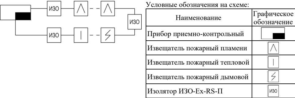
Рисунок 3 – Условная схема включения изолятора в АЛС
