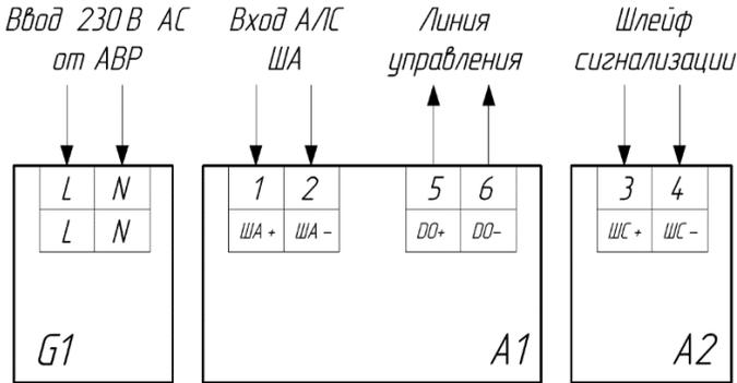
Рисунок 1 – Схема подключения УС
