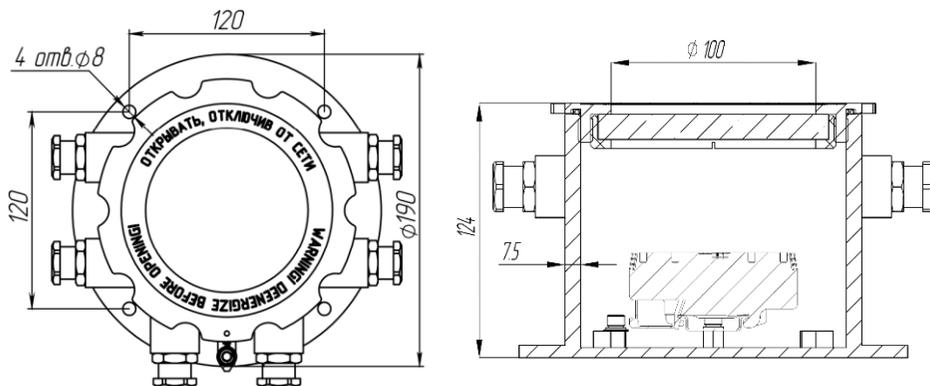
Рисунок 5 – Габаритные и установочные размеры УС
