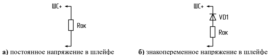
Рисунок 8 - Оконечный элемент контроля шлейфа ППКиУП
