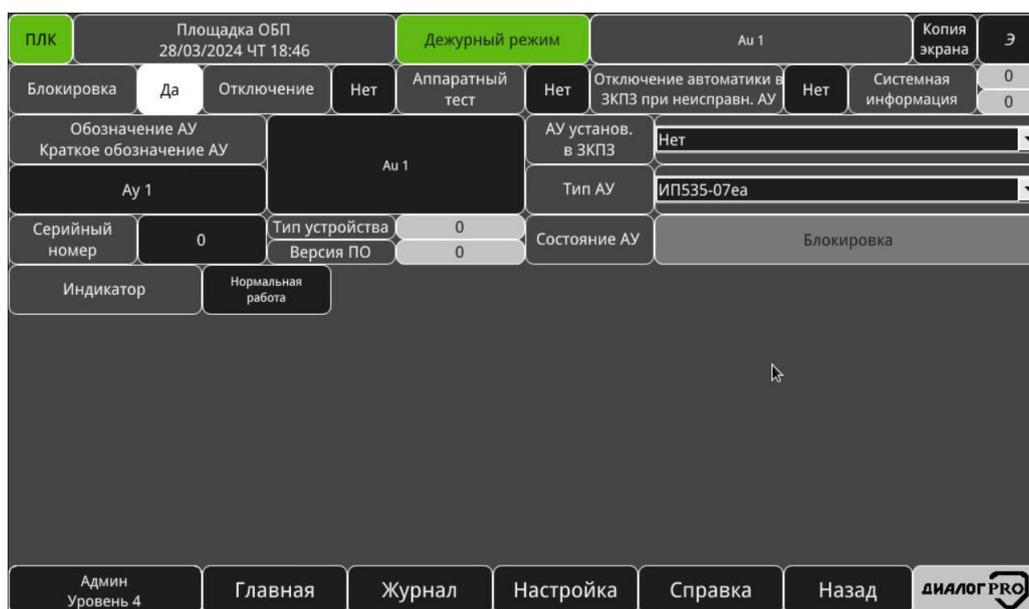
Рисунок 3.96 – Конфигурация «ИП535-07еа-ДПРО, ИП513-3FS», «ИП535-07еа «Пуск»-ДПРО, УДП-3SF», «МС-2»
