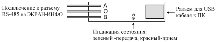
Рисунок 6. Расположение контактов преобразователя ПИ1.
