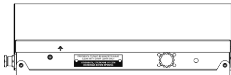
в) исполнение оповещателя с двумя кабельными вводами, расположенным влево (2ВЛ)
