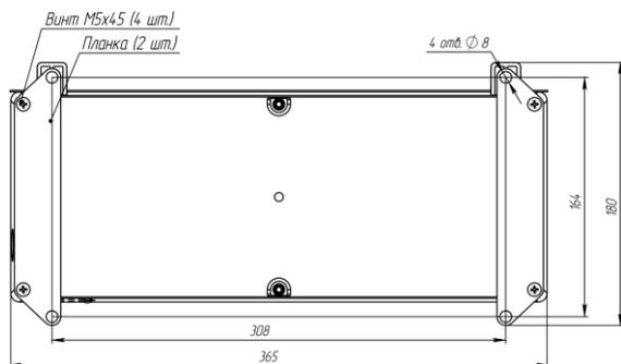
**в) Монтаж планок АК-4Э (вид сзади)**
