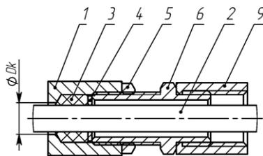
б) монтаж в трубной разводке с помощью штгцера **ШТГ**
