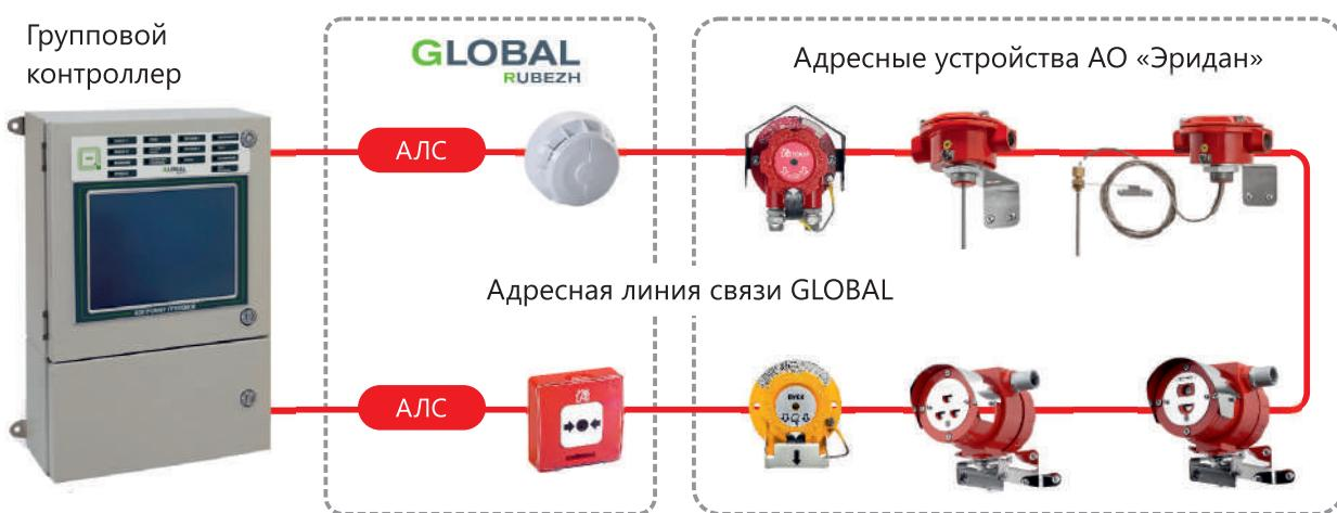
Также возможна интеграция адресных технических средств СПЗ GLOBAL RUBEZH в СПЗ «Диалог Pro». Структурная схема такой интеграции представлена на рисунке ниже. Количество адресных линий к одной базовой станции определяется при конфигурировании.
