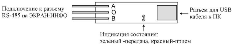
**Рисунок 6.** Расположение контактов преобразователя ПИ1.
